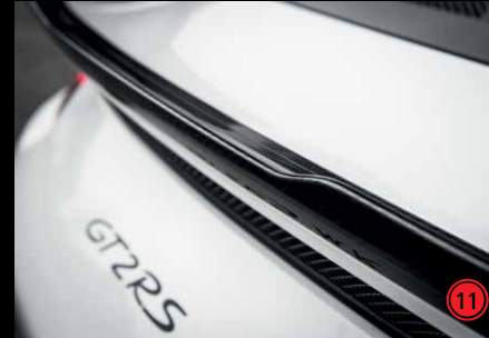
MR CARBON GURNEY* Abrisskante in Leichtbauweise zur Abtriebsoptimierung
