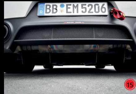
MR DIFFUSOR* Abtriebsoptimierter hinterer Unter- boden
